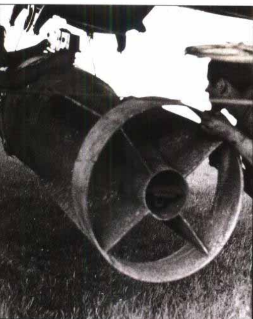
德国空军人员小心翼翼地把 SC—1800 型炸弹悬挂在海因克尔—III 型轰炸机下面。为了防止提前爆炸，炸弹安装了电动导火线，定时进行引爆。
